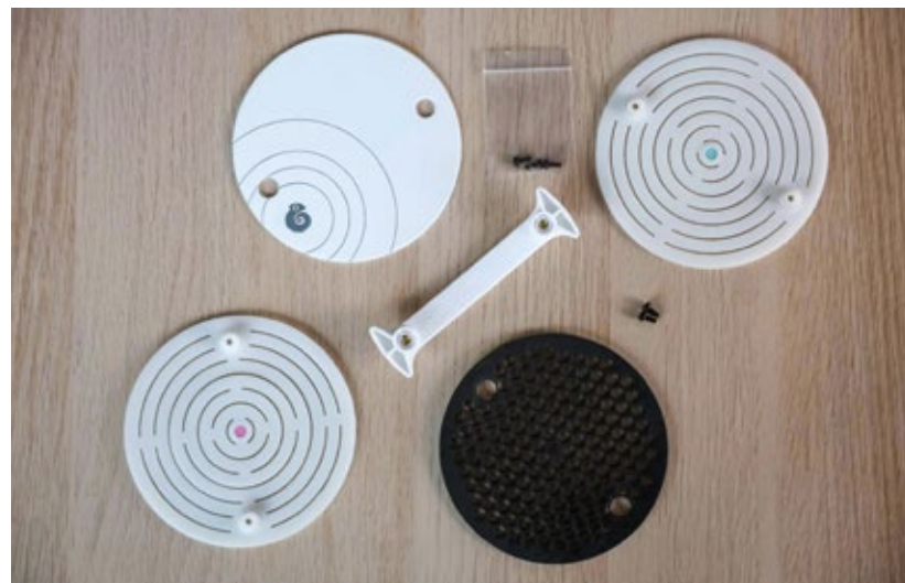
il. 24. Baren drukowany na drukarce 3D zaprojektowany i wykonany przez Jack Moranetz
