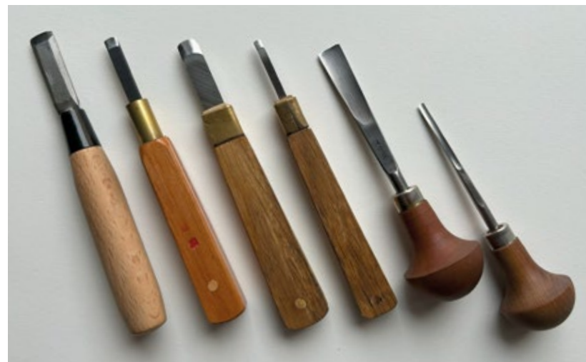
il. 14. Patrząc od lewej dłuta: dwa pierwsze – aisuki japońskie, dwa kolejne – aisuki mojej produkcji, dwa ostatnie – Pfeil prawie płaskie „U”
