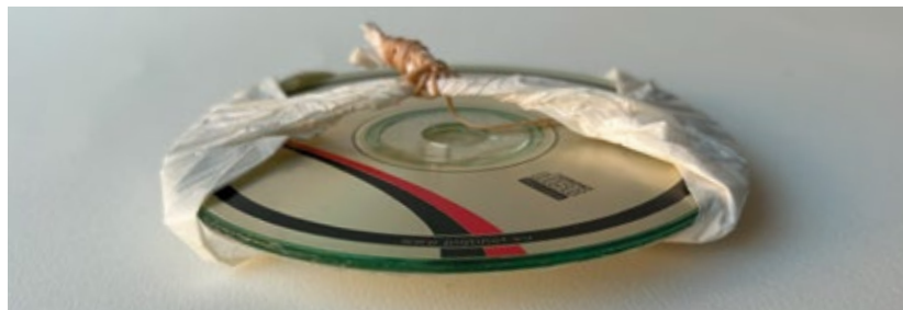
il. 26. Baren wykonany z płyt CD i maty antypoślizgowej zawinięty w papier do pieczenia
