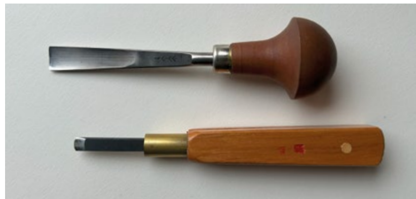
il. 17. Dłuto Pfeil (na górze) – przykład dłuta stosowanego w drzeworytnictwie zachodnim, dłuto japońskie z wysuwającym ostrzem (na dole)
