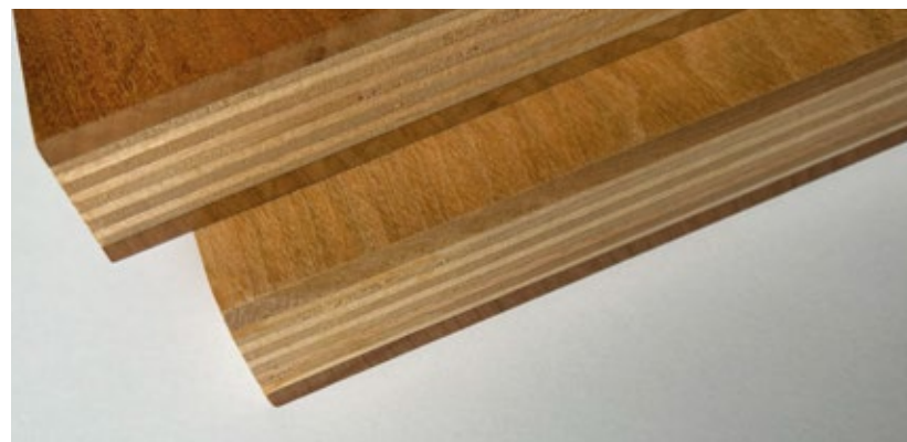
il. o7. Płyta trójwarstwowa. Zewnętrzne okładziny wykonane z drewna Yamazakura
