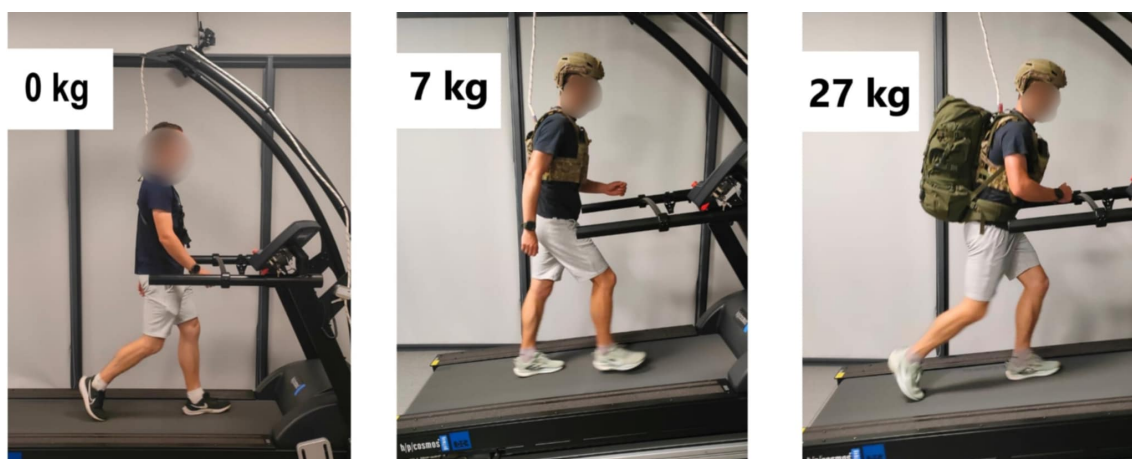
Rycina 4: Próba chodu w różnych warunkach obciążenia
